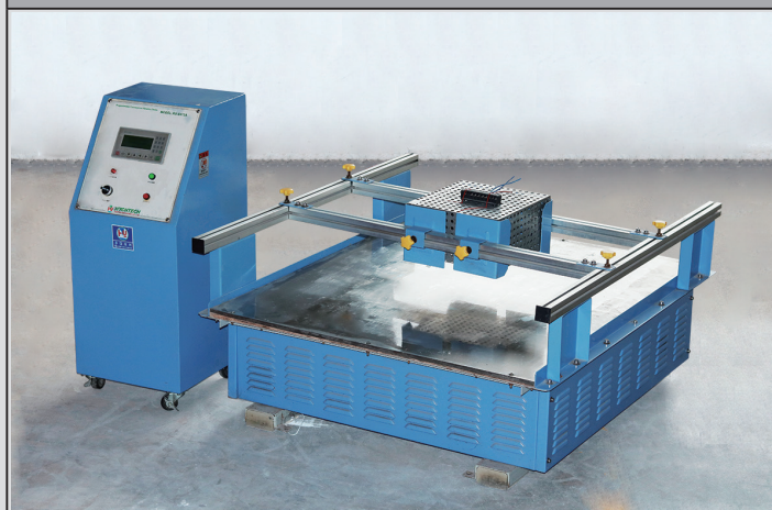
Machine d'essai aux vibrations
